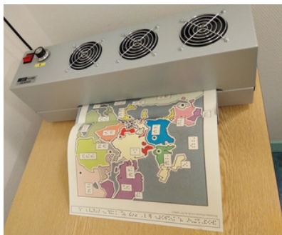
Illustration 30: Production d'un dessin thermogonflé
