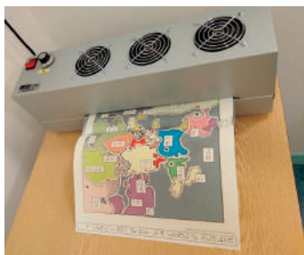
Illustration 30: Production d'un dessin thermogonflé
